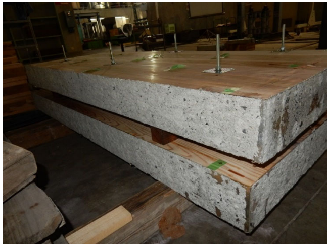
写真 2-21 試験体 BS の損傷状況 (CLT 袖壁取り外し後)
