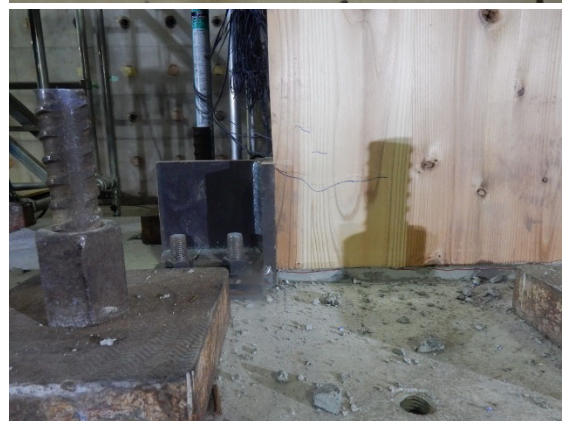
写真 3-39 試験体 B の 1F 袖壁における目地部分の損傷状況 (R=1/25)
