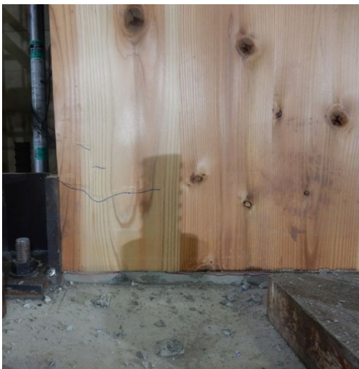
写真 3-31 CLT 袖壁の圧縮しわ及び亀裂 (R=1/25)
