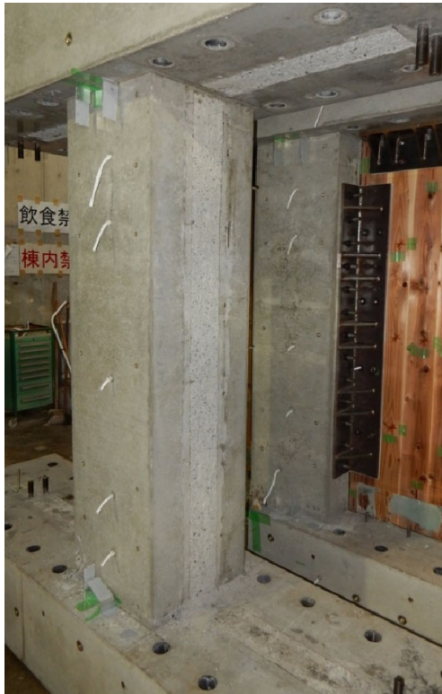
写真 2-21 試験体 BS の損傷状況 (CLT 袖壁取り外し後)
