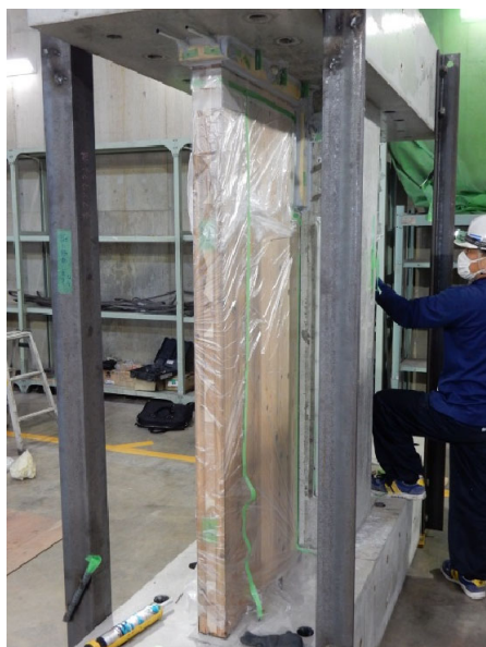
写真 2-9 2 回目のエポキシ樹脂充填のための型枠、目地材の設置、試験体の養生
