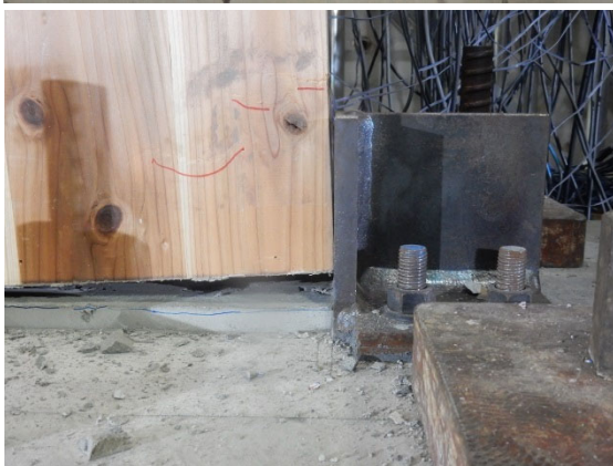
写真 3-39 試験体 B の 1F 袖壁における目地部分の損傷状況 (R=1/25)
