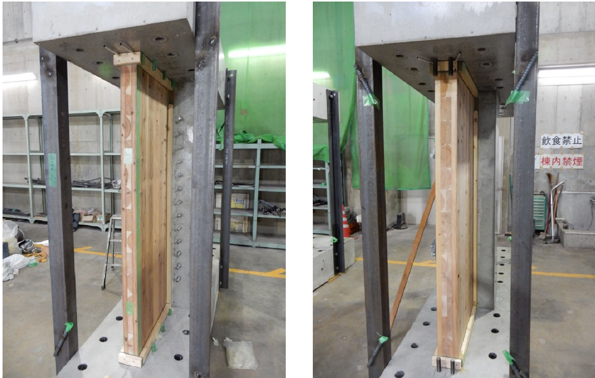
写真 2-5 型枠設置終了後の様子
