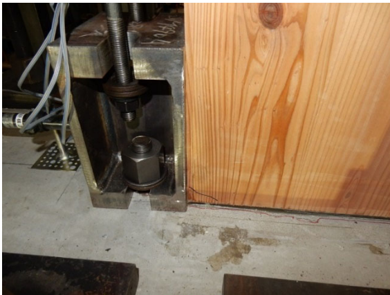
(b) CLT 袖壁の端部の亀裂 ( R=1/100 )
