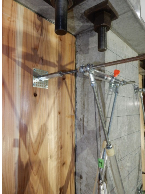
(a) CLT 袖壁—RC 柱間の境界面に沿ったひび割れ ( R=1/100 )
