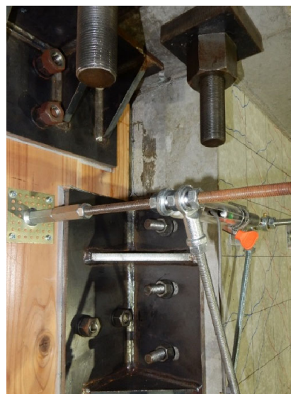
(a) CLT 袖壁—水平接合材間のずれと CLT 袖壁—RC 柱間のひび割れ ( R=1/100 )
