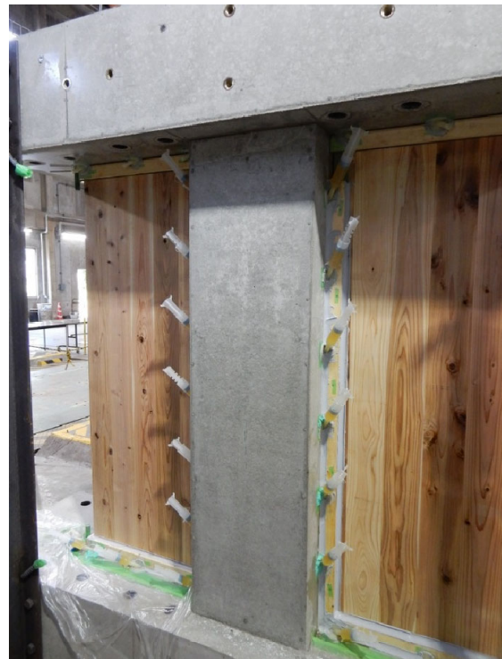
写真 2-7 1 回目のエポキシ樹脂の充填時の様子
