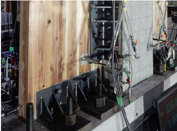
(d) CLT 袖壁の端部の亀裂 ( R=1/100 )
