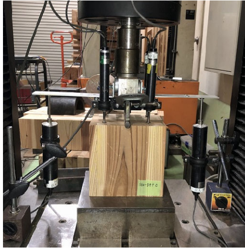
写真 3-11 変位計の設置状況
