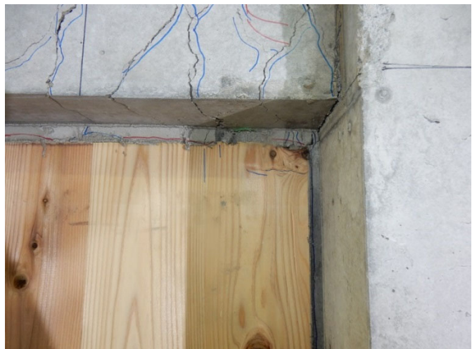
写真 3-31 CLT 袖壁の圧縮しわ及び亀裂 (R=1/25)
