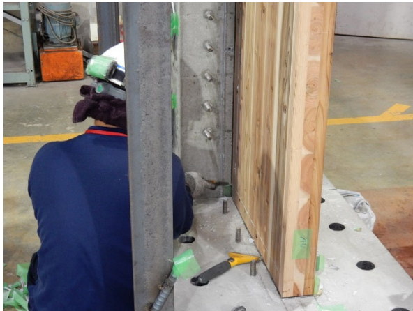
写真 2-8 1 回目のエポキシ樹脂充填後の脱型時の様子
