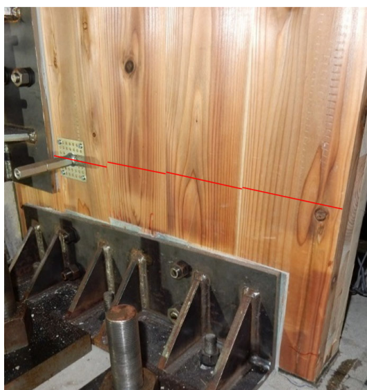
(c) 最終的な破壊性状 ( R=1/20 )
