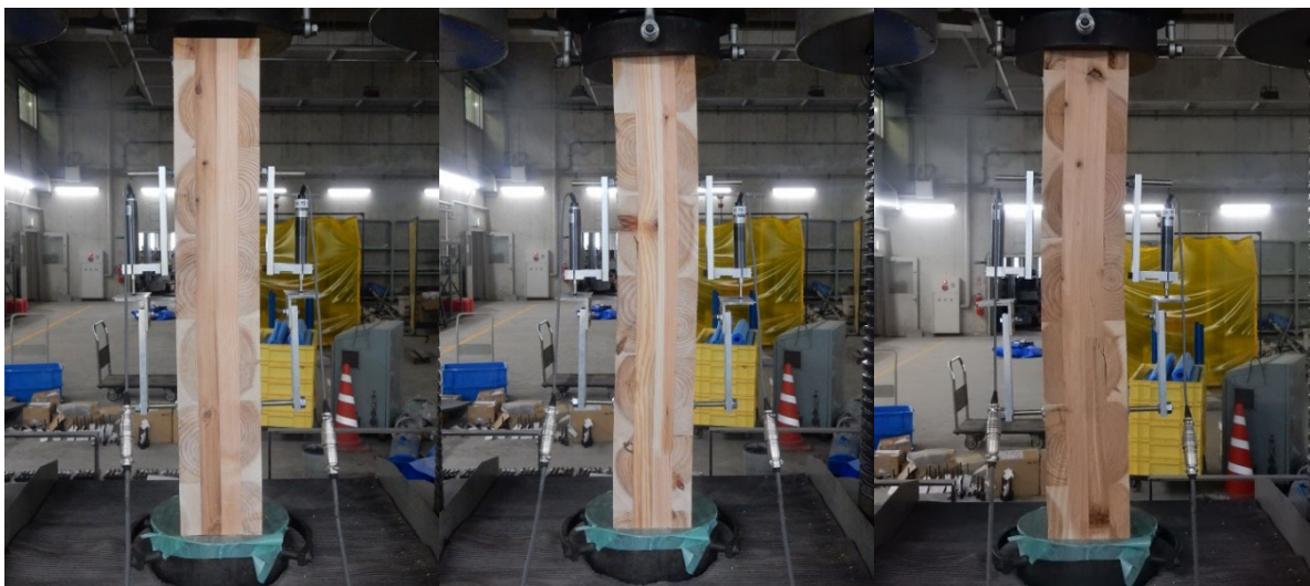
写真 3-9 横圧縮試験の様子
