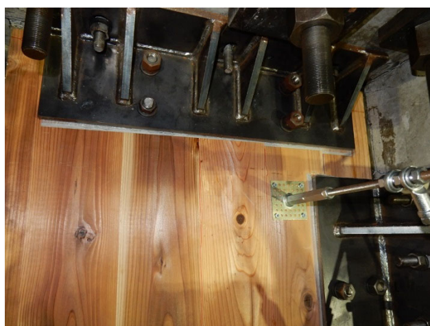
(b) CLT 袖壁—水平接合材間のずれ ( R=1/50 )
