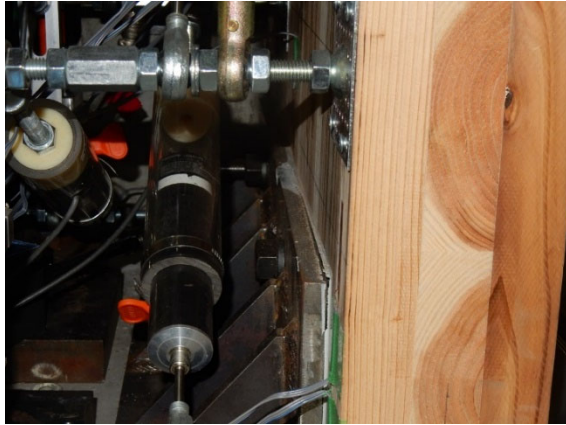
(a) CLT 袖壁—水平接合材間の亀裂とずれ ( R=1/133 )
