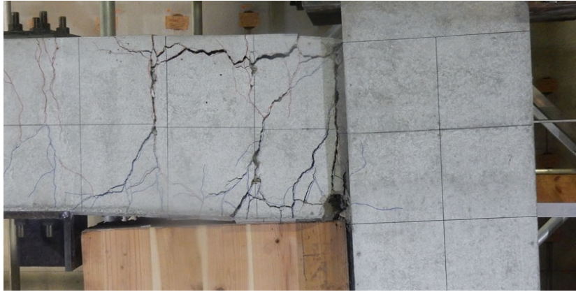
写真 3-29 RC はりの損傷 (R=1/33)
