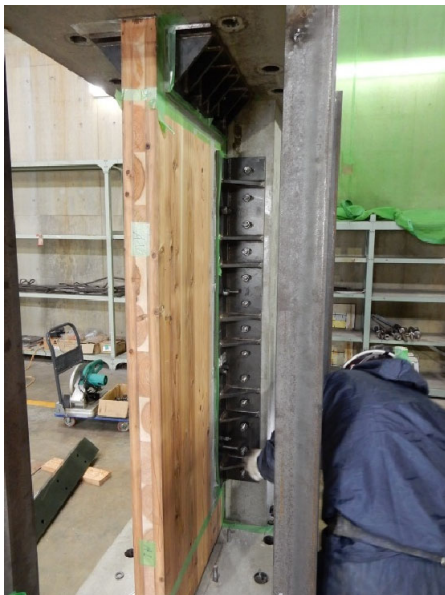
写真 2-14 鉛直接合材の接着時の様子
