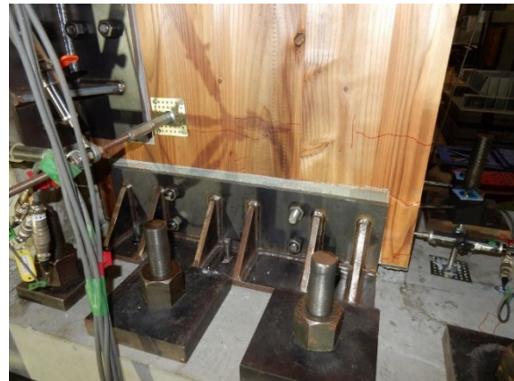
(b) CLT 袖壁—水平接合材間の亀裂とずれ (左 R=1/100 、右 R=1/50 )
