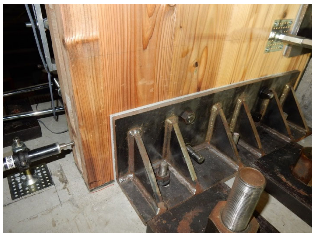
(a) CLT 袖壁—水平接合材間のずれと CLT 袖壁—RC 柱間のひび割れ ( R=1/100 )
