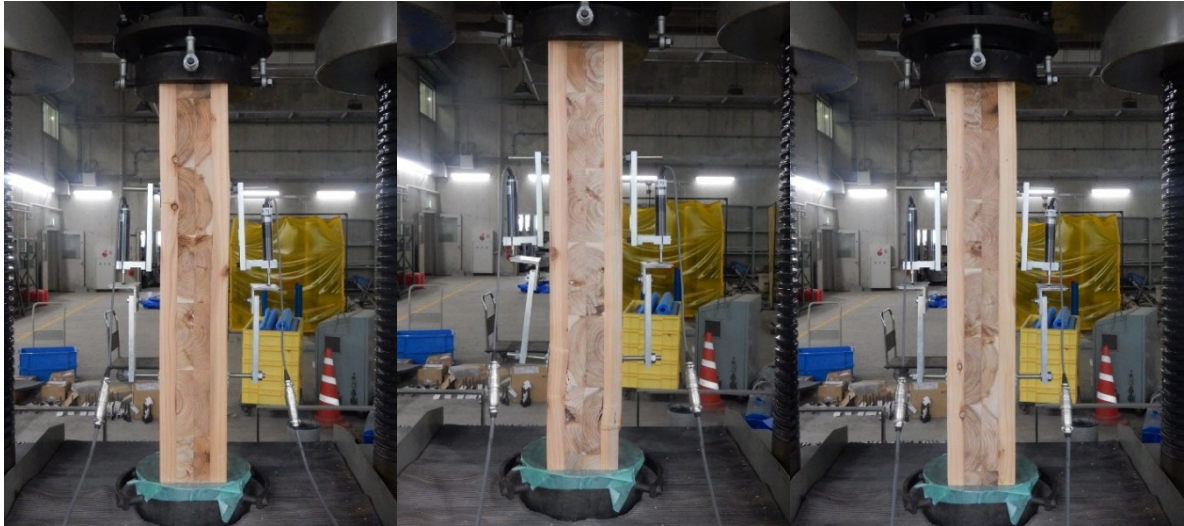
写真 3-8 縦圧縮試験の様子
