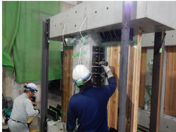
写真 2-14 鉛直接合材の接着時の様子
