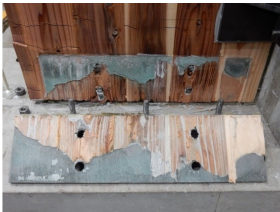
(c) CLT 袖壁—水平接合材間の破壊面の様子 (実験終了後) 写真 2-19 試験体 AS の損傷状況
