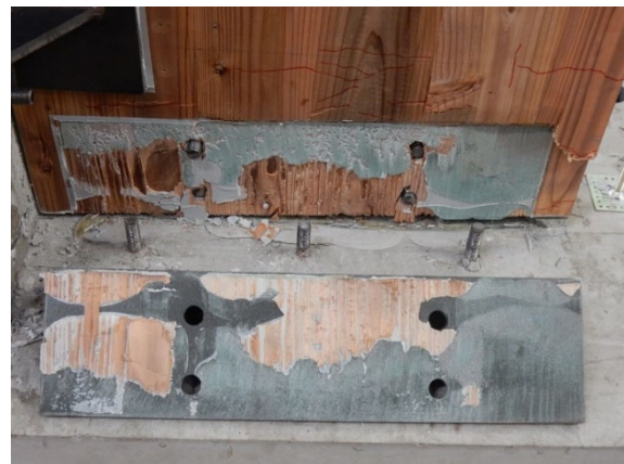
(c) CLT 袖壁—水平接合材間の破壊面の様子 (実験終了後) 写真 2-19 試験体 AS の損傷状況
