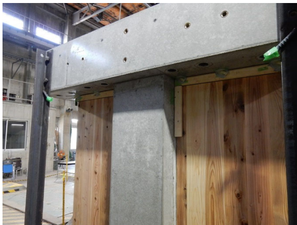
写真 2-8 1 回目のエポキシ樹脂充填後の脱型時の様子
