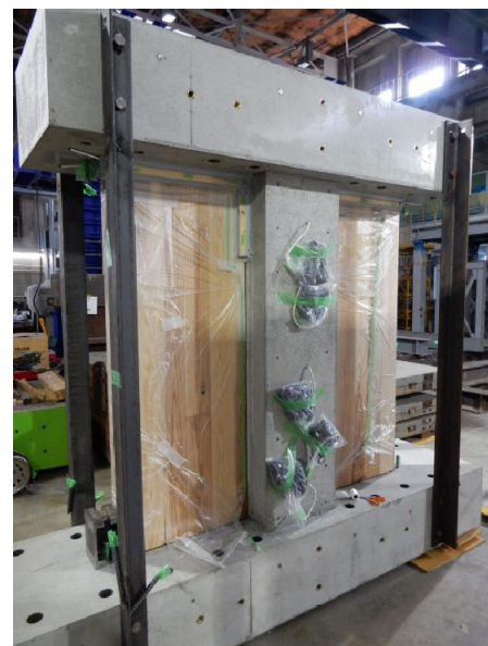
写真 2-9 2 回目のエポキシ樹脂充填のための型枠、目地材の設置、試験体の養生
