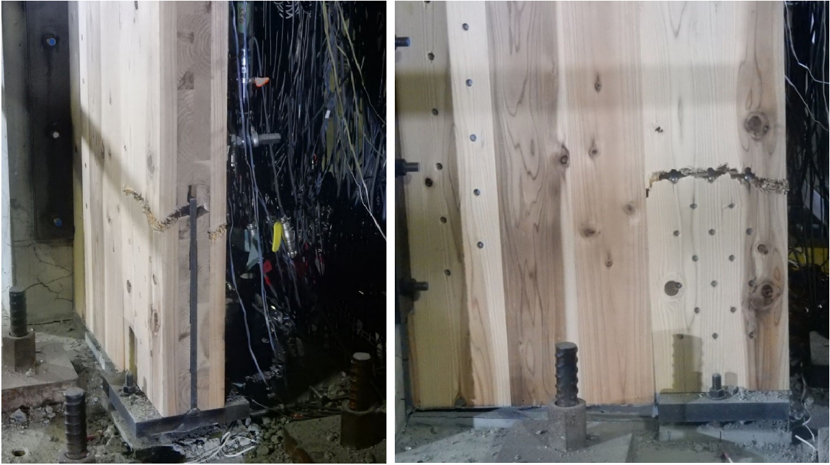
写真 3-22 ドリフトピン接合部の破壊 (R=1/25)
