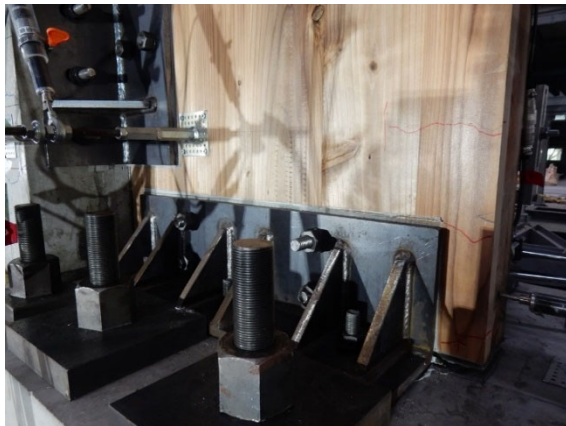
(b) CLT 袖壁—水平接合材間の亀裂とずれ (左 R=1/100 、右 R=1/50 )
