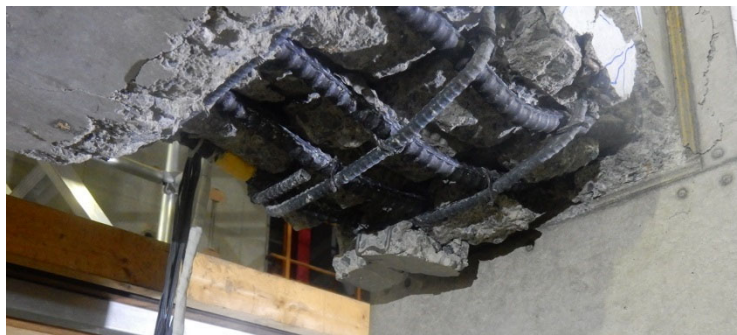
写真 3-37 RC はりあばら筋のフックの開き (R=1/20)
