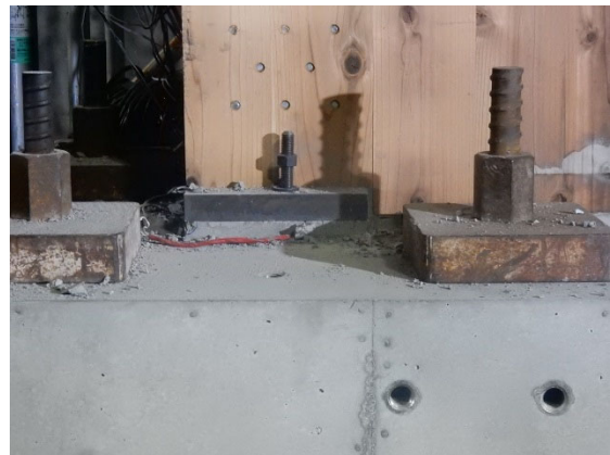
写真 3-38 試験体 A の 1F 袖壁における目地部分の損傷状況 (R=1/25)
