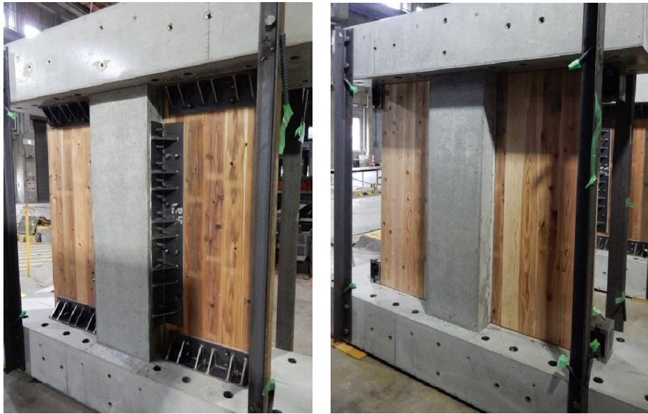
写真 2-16 施工終了時の試験体の様子
