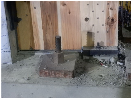
写真 3-38 試験体 A の 1F 袖壁における目地部分の損傷状況 (R=1/25)
