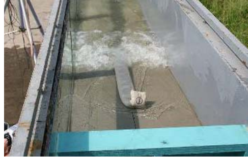
写真-2 袋詰め工の端部におけるめくれあがり
