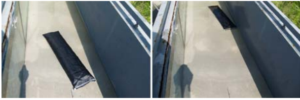
写真-1 袋詰め工の滑動 (左:造波前, 右:造波後)
