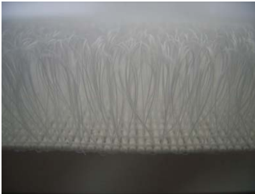
写真-12 PILEシートの拡大写真
