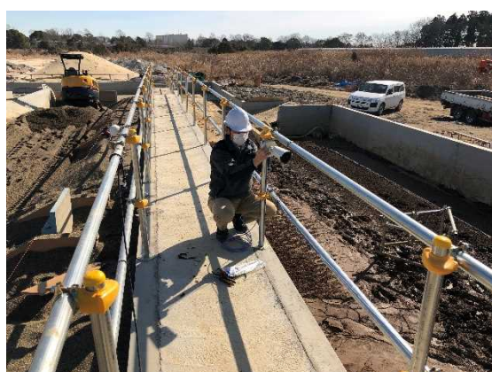
写真 4-3 傾斜計センサー（左）とカメラ（右）設置状況
