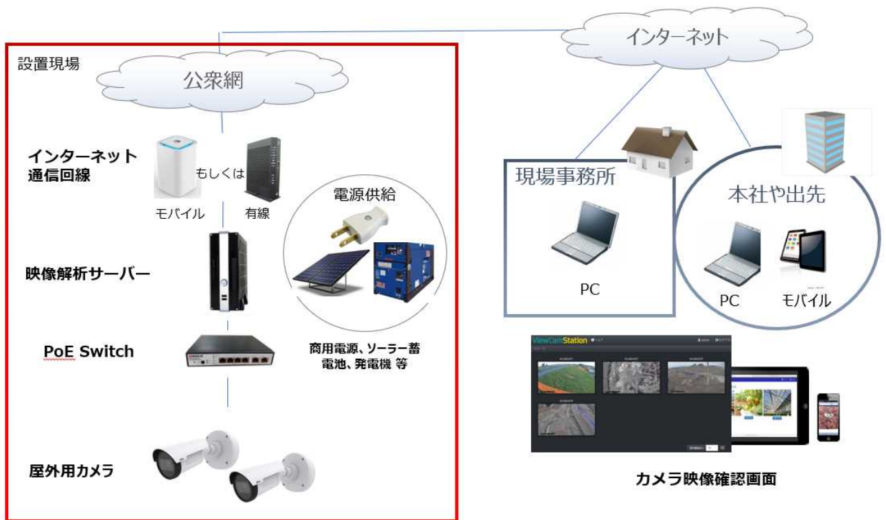
図 4-2 映像データ及び解析データ取得システム概略図
