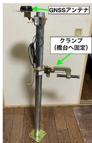
図13 観測局3及び橋台への取付け治具
