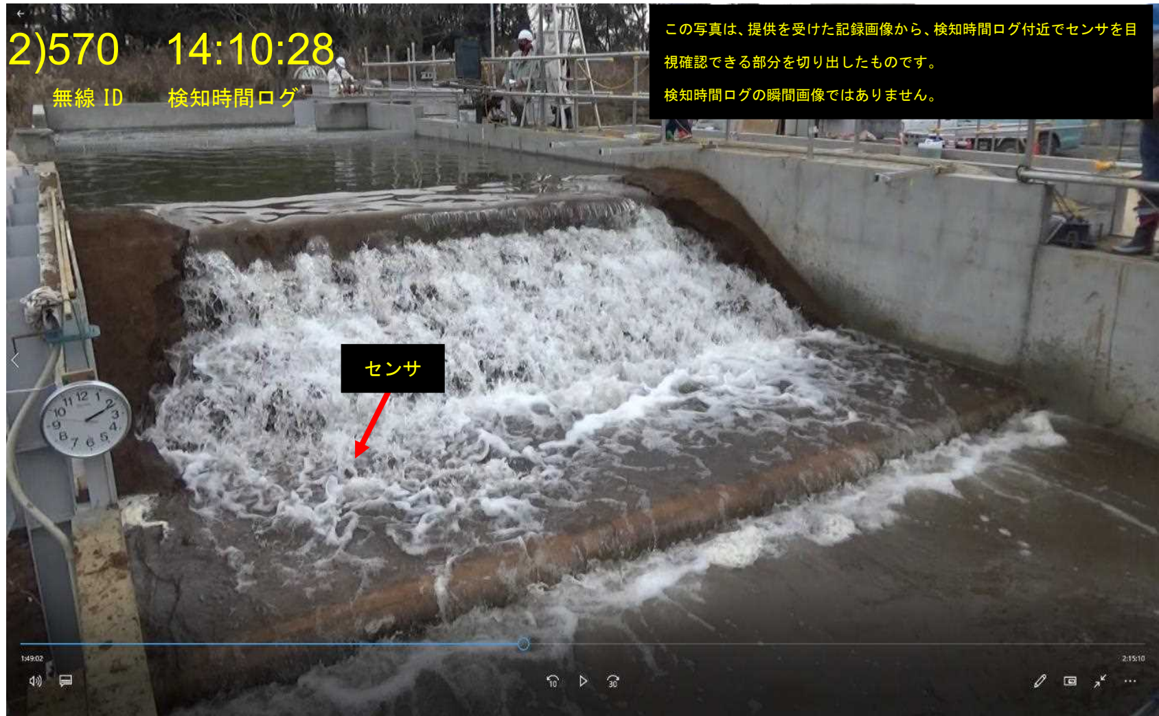
図 36 越水試験検知写真 (2)
