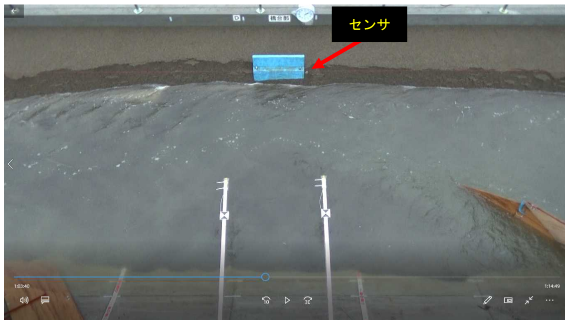
図 50 橋台脇のセンサ (ずり落ちていた)
