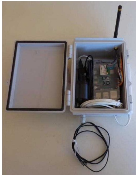
図 10 試験用受信装置（無線 LAN 伝送、190 mm×120 mm×100 mm、質量 1.5kg）
