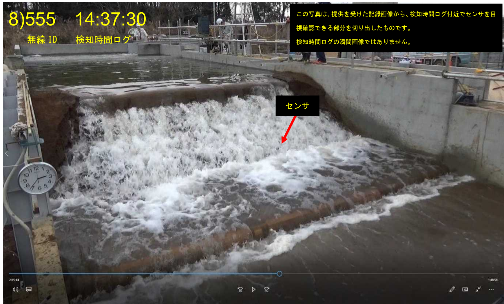
図 42 越水試験検知写真 (8)
