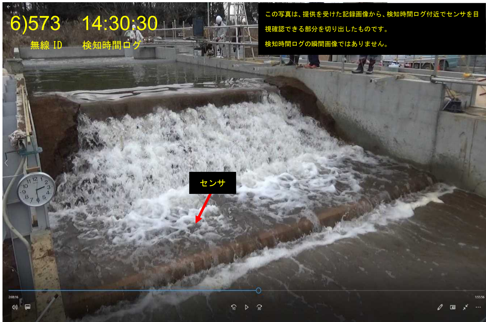
図 40 越水試験検知写真 (6)
