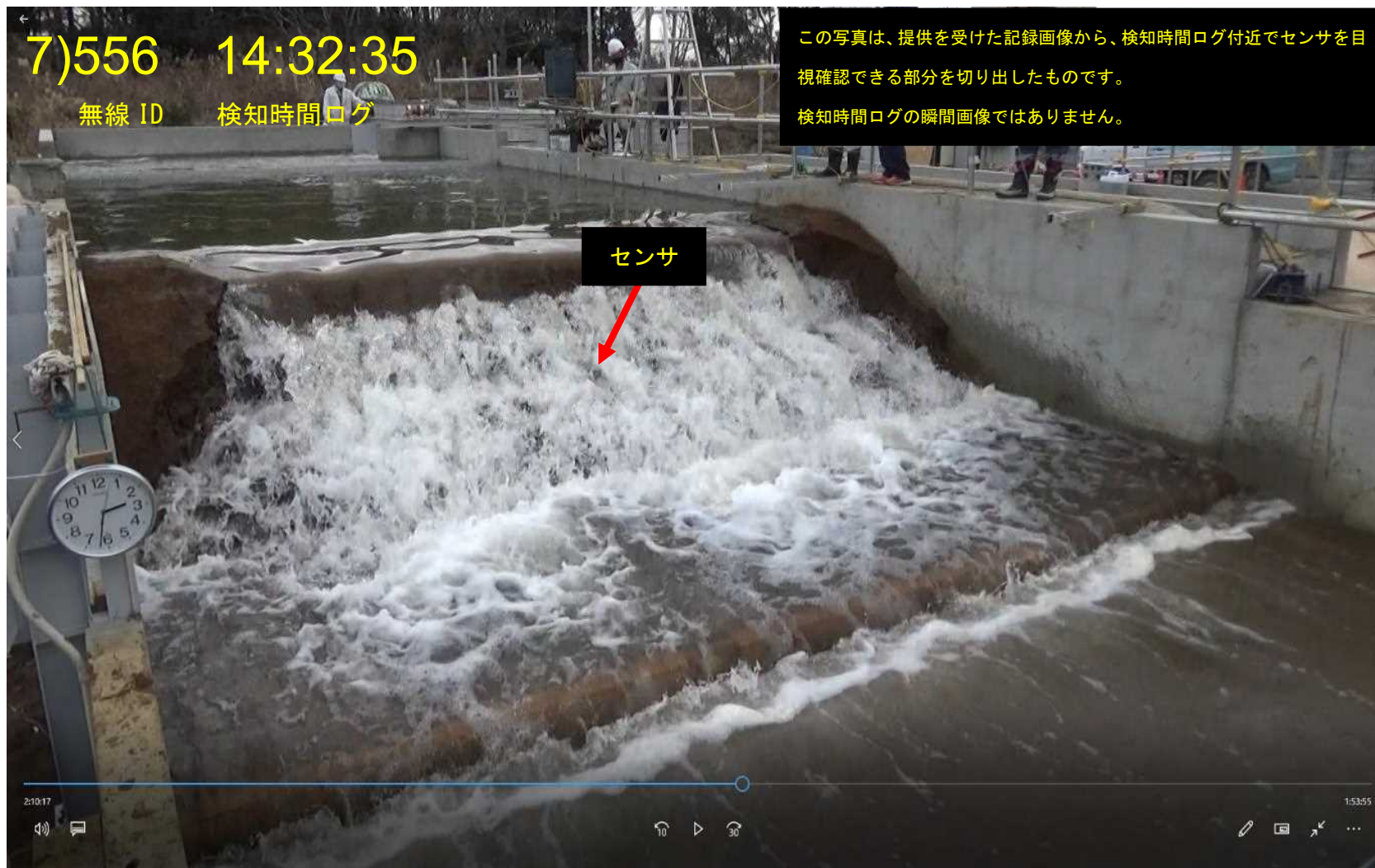
図 41 越水試験検知写真 (7)
