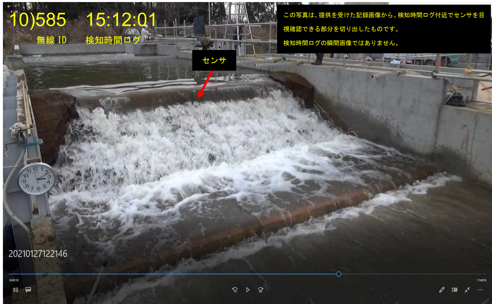
図 44 越水試験検知写真 (10)
