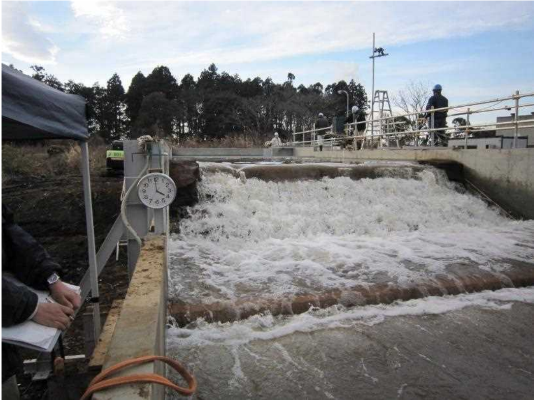
図 47 越水試験（午後4時 終了直前）
