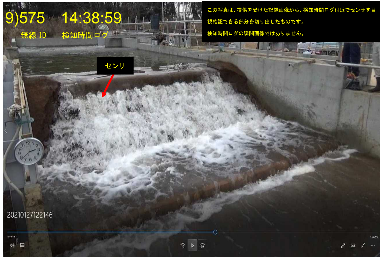
図 43 越水試験検知写真 (9)
