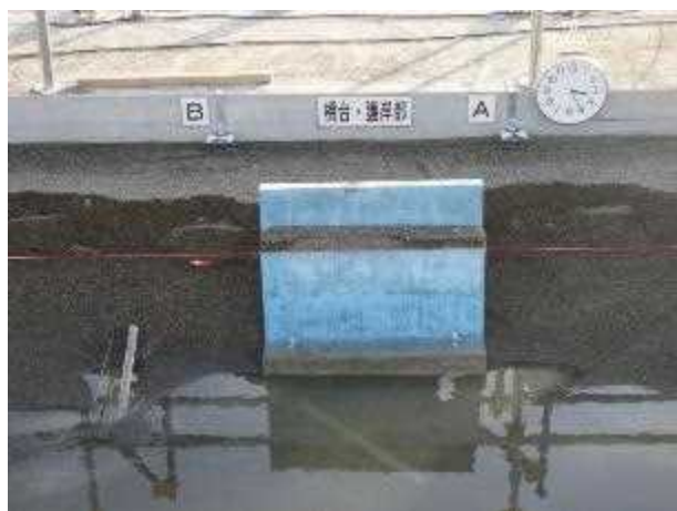
写真 6-1 実験後の振動補助金物（「一般部」「橋台部」「護岸橋台部」）
