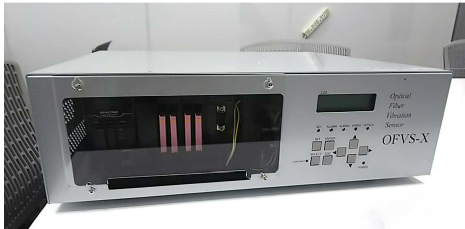
写真 2-1 振動検知システム 計測装置外観
