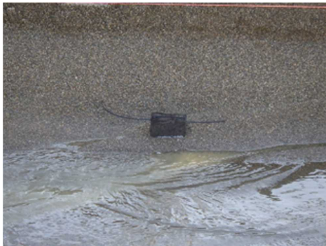
写真付 6-1 浸水検知センサの実験完了後の状況
