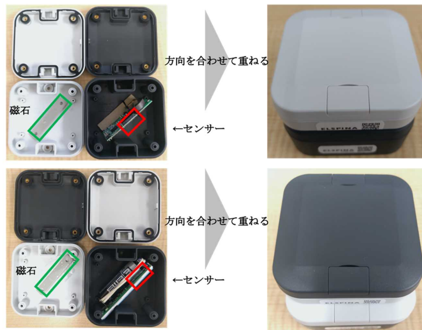
図 7 埋設時の磁石側とセンサー側の方向合わせ
