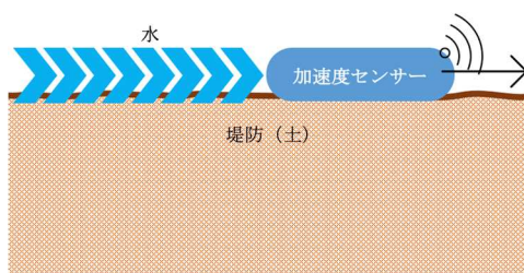
図 2 加速度センサーによる変状検知
