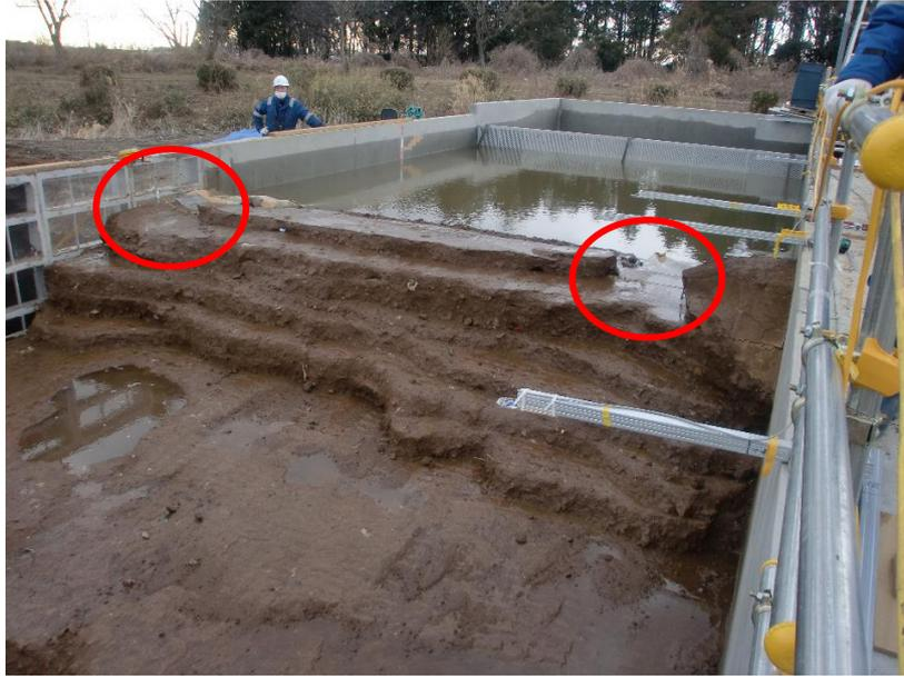
図 4.2-8 実験後の堤防の状況 (15 時 41 分)
