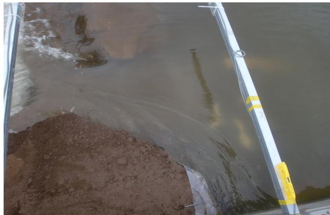
図4.2-7 堤防天端の溝切り洗掘部（14時26分）
