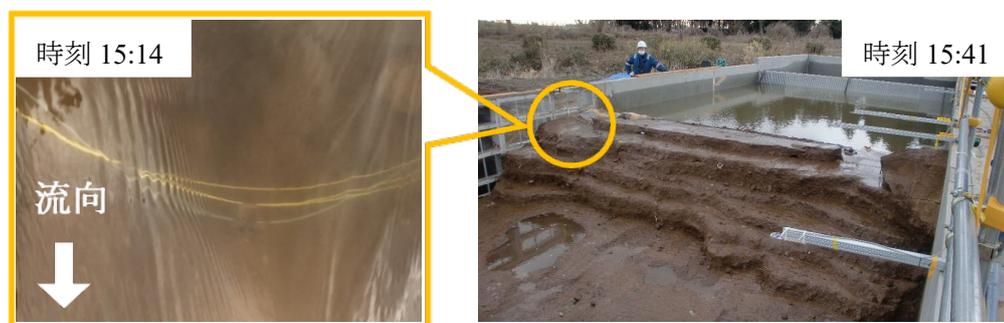
図4.4-9 越水実験で露出し水圧を受けるケーブル
