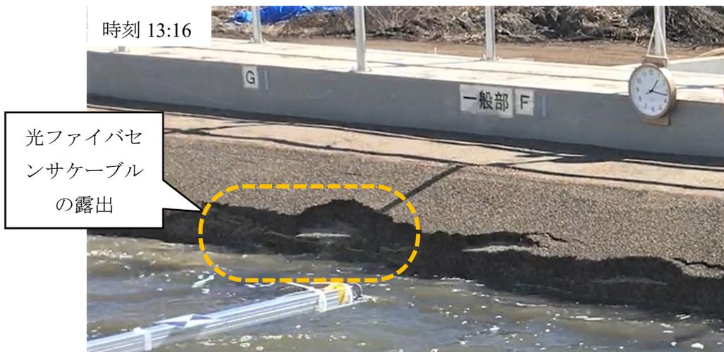
図4.4-14 一般部の法面崩落
