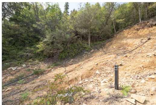
斜面災害検出目的で設置した9軸センサ杭
