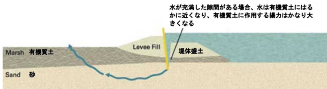
図 1-2 被災メカニズムの概要（パイピング）
