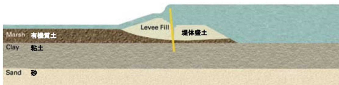
矢板背後の地盤の洗掘により、矢板の支持力が低下
