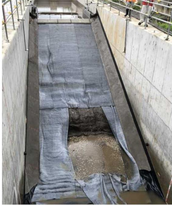
写真 2-1 3 時間通水後の堤防模型の状況
