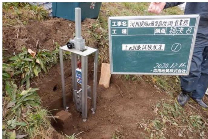
写真 2.3-5 引張破壊応力試験の様子
