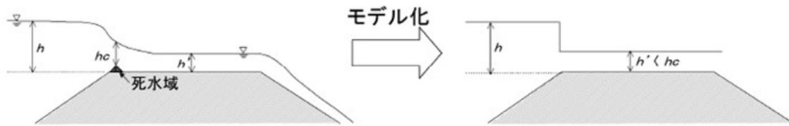
図 5.4-7 堤防天端の越水のモデル化
