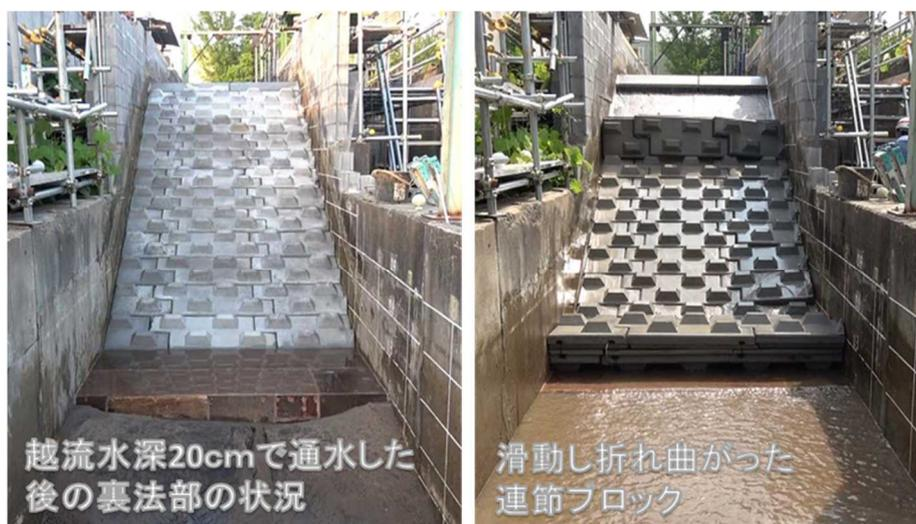
写真 5.4-2 被覆ブロックが折れ曲がった事例
