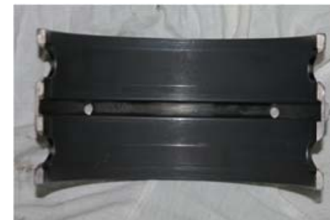
N排水機場 クランクピンメタル
