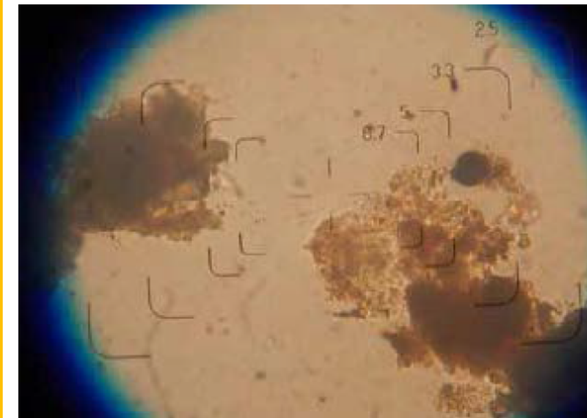
顕微鏡により確認された鉄バクテリアのフロック(褐色の物質) <錆汁成分を顕微鏡で見たもの>
