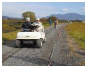
道路盛土や河川堤防などの土構造物の新規建設や既設構造物の防災・維持管理のためには、浅部の地盤構造や物性分布を把握することが必要である。そこでそれらをイメージングし、弱点箇所を効的に抽出できる物理探査手法を研究・開発した。電気探査と表面波探査等を組み合わせて適用する統合物理探査技術である。本技術の手法をまとめた「河川堤防のための統合物理探査－適用の手引き(案)－」(平成25年1月出版)についても紹介する。
