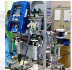
電子制御混合式エアレススプレー塗装機
