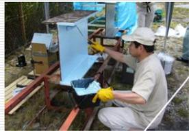
塗料粘度・温度測定、ローラー塗装作業性の試験結果(気温26℃)
