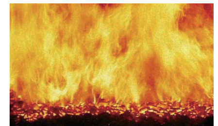
炉内: 900℃以上の高温燃焼域(火災)が形成されることでN 2 Oが抑制される
