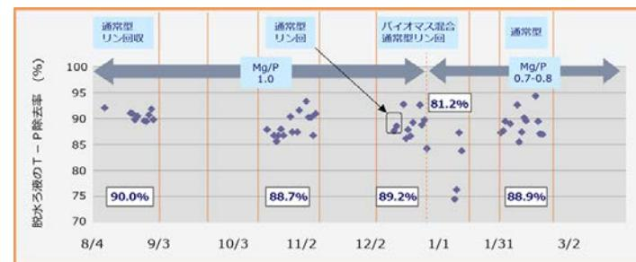
脱水ろ液のT-P除去率(経日変化)
