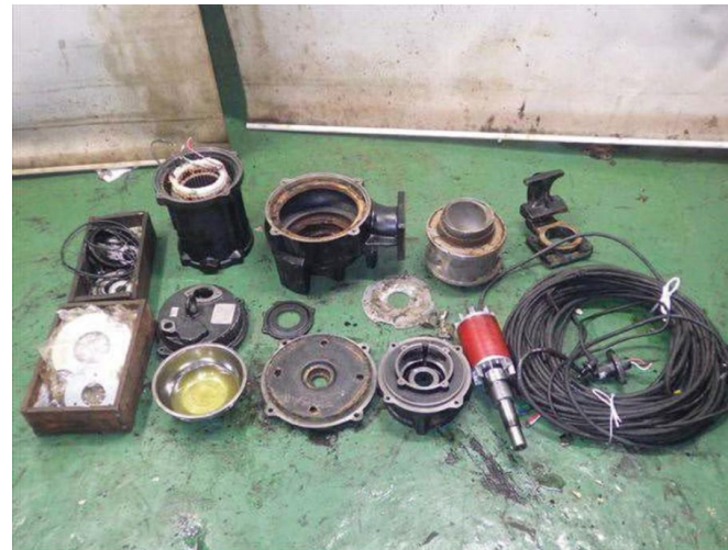
汚水ポンプ修繕 (2019年9月撮影)
