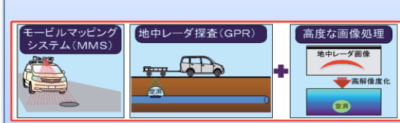
陥没の原因となる空洞を効率的に発見
