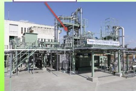
遠心脱水機と乾燥機を組み合わせた脱水乾燥システム
