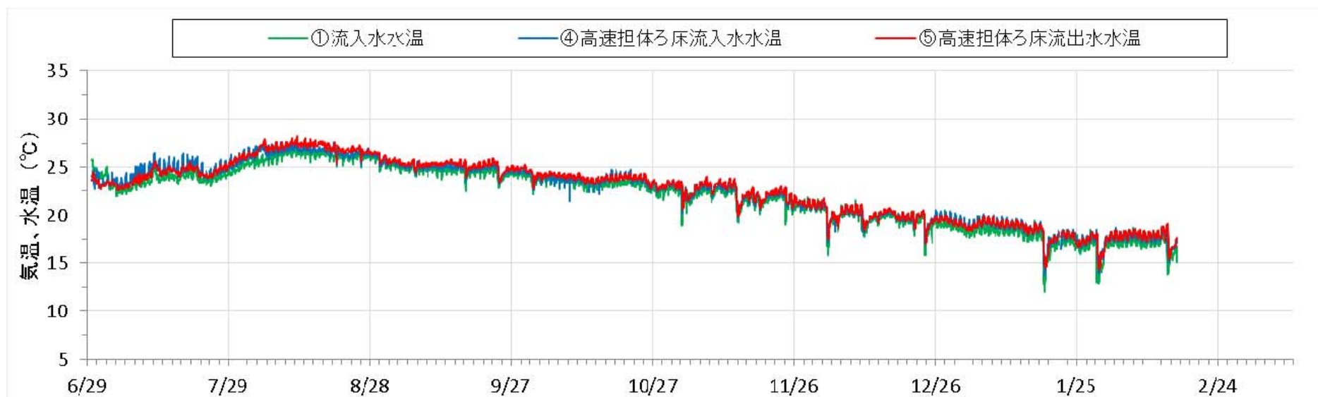
流入水、高速担体ろ床流入水および流出水の水温の変化
