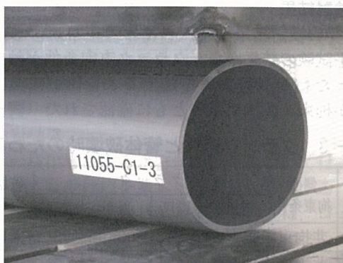
写真-5 偏平試験状況（管体非拘束条件）
