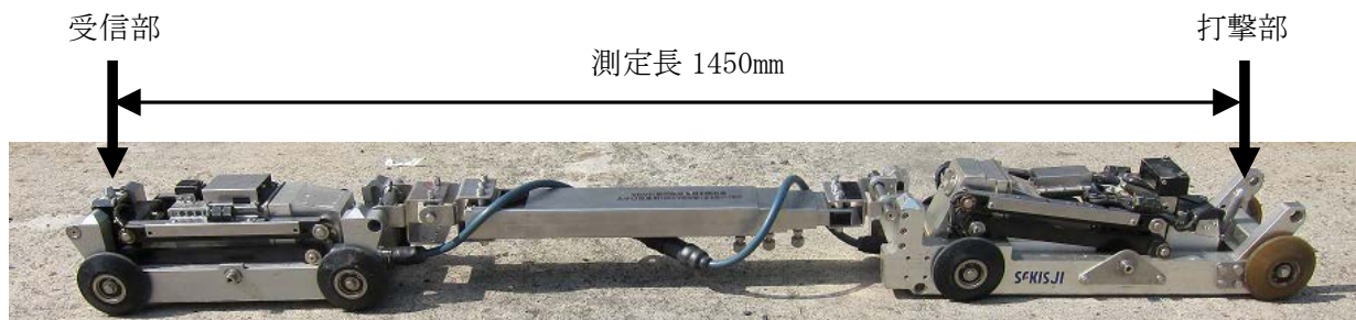
図 2-8 衝撃弾性波検査法装置の外観
