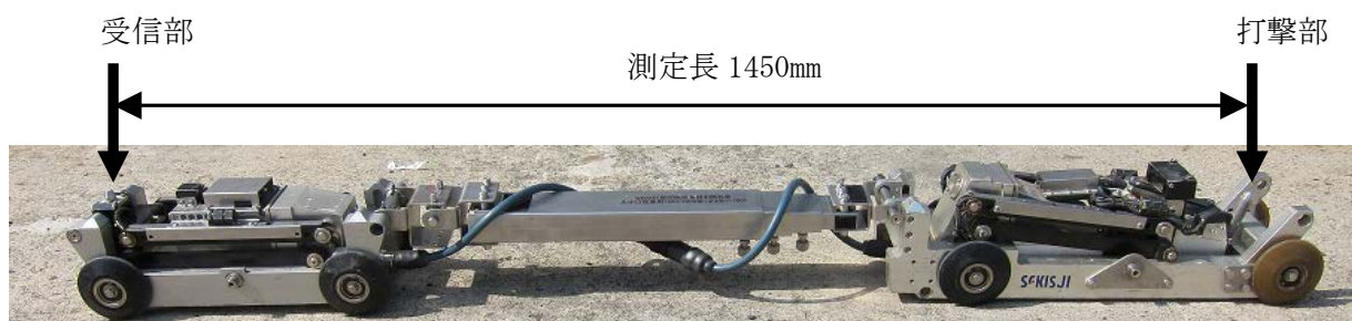
図 5-5 衝撃弾性波検査法装置の外観
