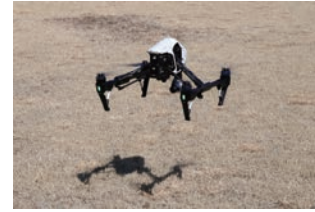
図-2 空撮に使用している小型 UAV
