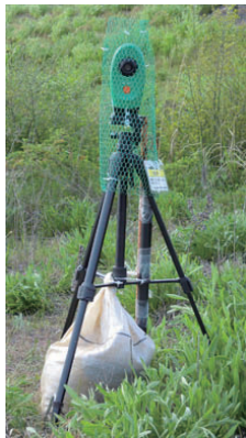
図-2 インターバルカメラの諸元および設置状況
