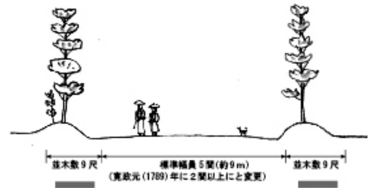
標準的な東海道の断面構成
