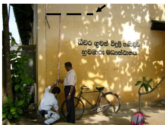
写真-5.1 ゴール漁港における浸水痕跡
