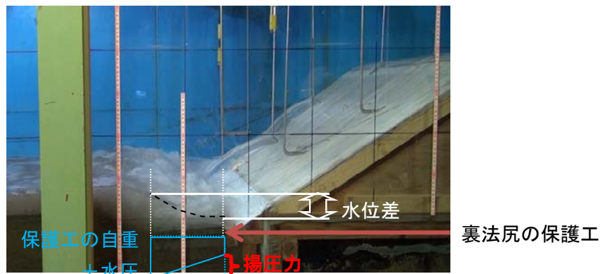
写真-6 跳水に伴う水位差による揚圧力
