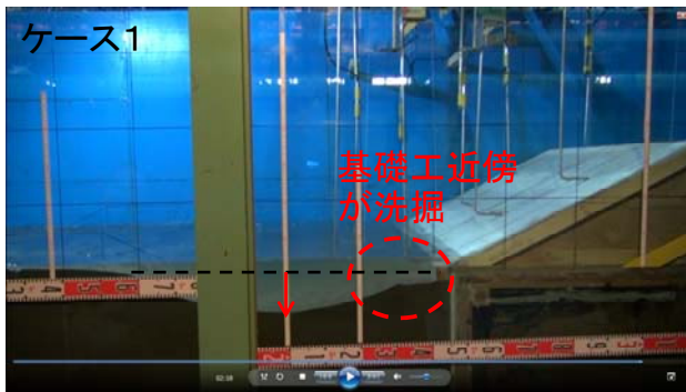
写真-3 越流後の地形（ケース 1）
