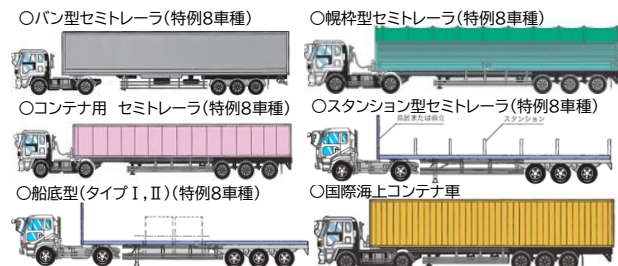
図-3 5軸セミトレーラの例(特殊車両ハンドブック2022より)
