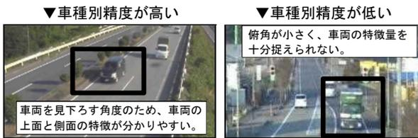
図-2 車種別精度の一例(カメラ設置高さ 8m)
