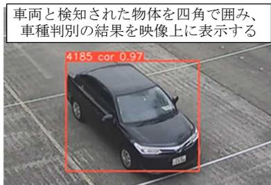
図-3 車両検知・車種判別結果表示 (一例)
