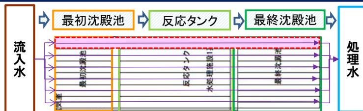
最初沈殿池から最終沈殿池まで、1系列がワンセットとしてつながっている
