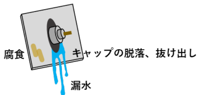
図3-3-3 ロックボルトの変状の例
