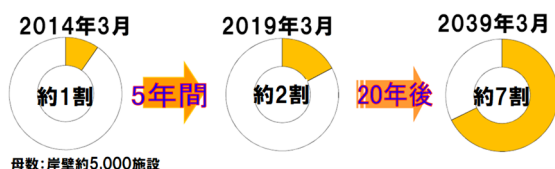
図-1.1 建設後50年以上経過する岸壁数の割合 4)
