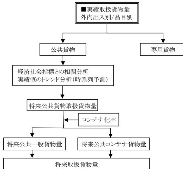
図-2 コンテナ化率を乗じてコンテナ貨物量を予測する基本スキーム
