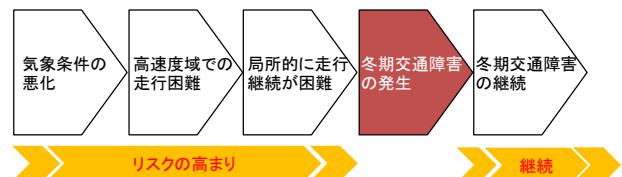
図-1 冬期交通障害の発生メカニズム
