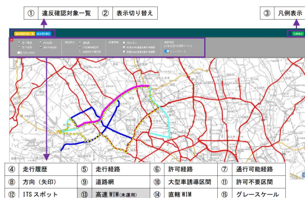
図-3 モニタリングシステムでの経路確認イメージ
