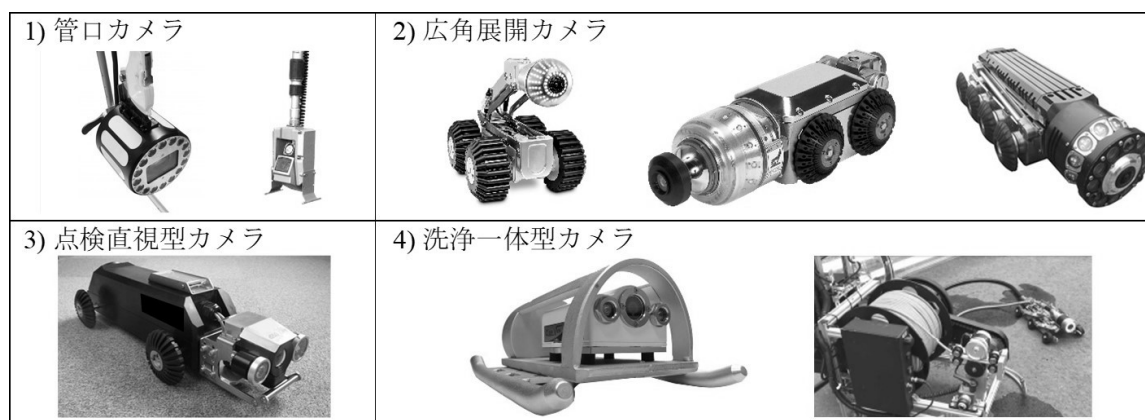
図2 本研究でコスト試算の対象とした簡易調査技術
