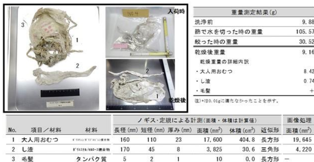
図1 マンホールポンプ不具合の原因物質の測定状況
