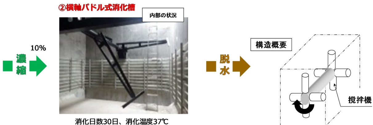
図 2-3 高濃度消化技術の概要
