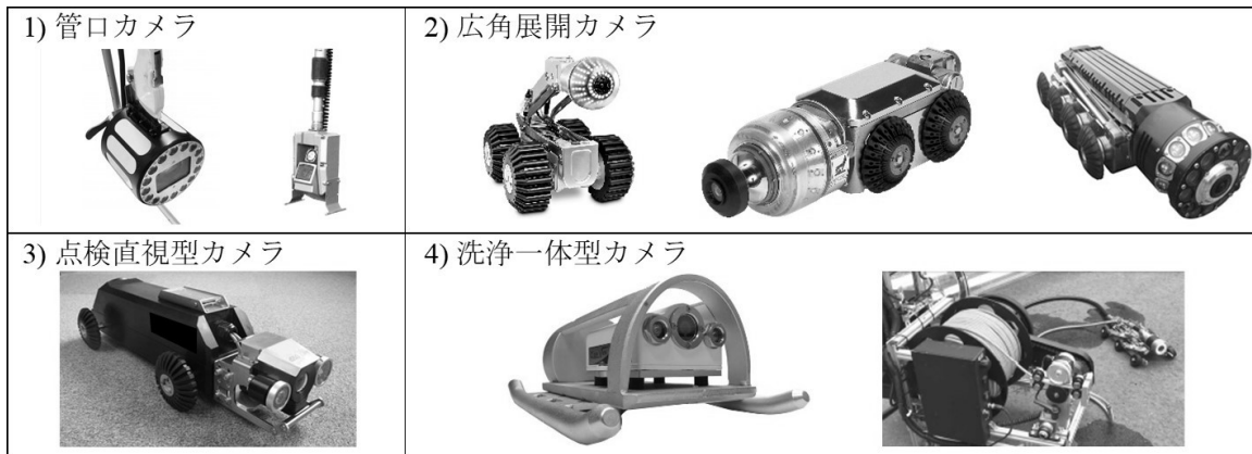
図 2-57 経済性試算において TV カメラ調査に組み合わせるスクリーニング調査技術
