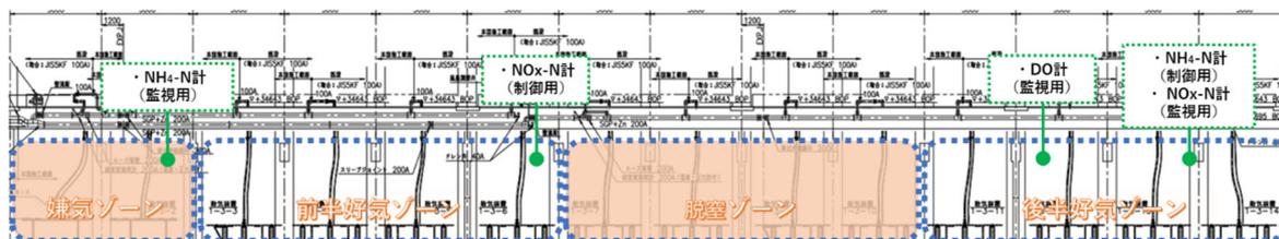
図資 4-4 水質計の設置位置と各ゾーンの位置関係 (1-1, 1-3, 1-4 系反応タンク断面)
