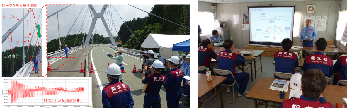
(1) ケーブル張力の確認試験状況 (2) 管理者に対する施工段階で取得したデータの維持管理への活用に関する説明
