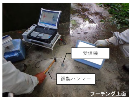
写真-4.5 高周波衝撃弾性波法による調査例
