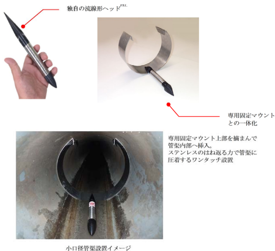
資図2-2 圧力チップの外観及び構造
