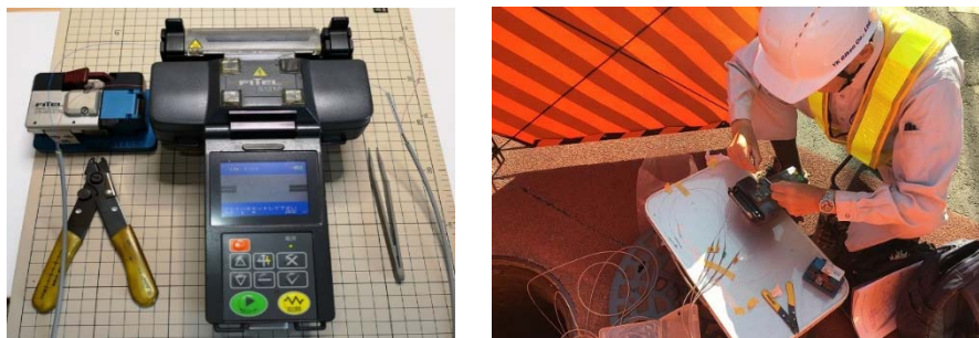
資図 2-23 光ファイバー融着接続機(左)と融着作業の状況(右)
