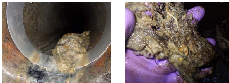
(左) 光ファイバーケーブルに付着したし渣の様子 (右) 付着したし渣(トイレtpペーパー、不溶性のティッシュペーパー、生理用ナプキン、髪の毛、不織布(ペーパータオル)、等)
