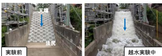
粘り強い堤防構造の検討手法を確立するため、大型堤防模型を用いた越水実験を実施
