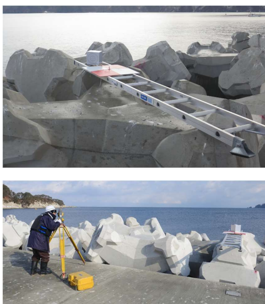
図-3.3 梯子による検証点の設置風景
