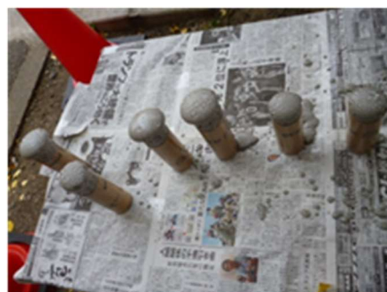
写真-2.1 供試体の作成状況
