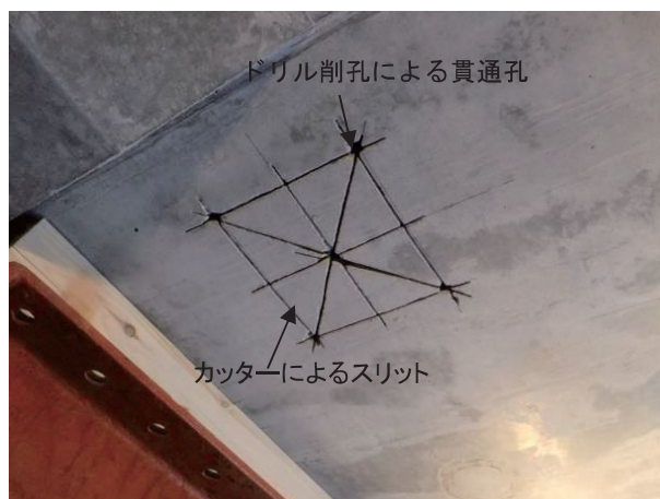
(a) スリット作製状況（供試体下面）
