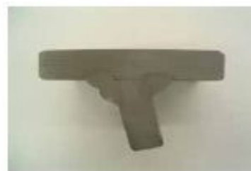
写真-1-2 マクロ試験結果（斜めウェブ）
