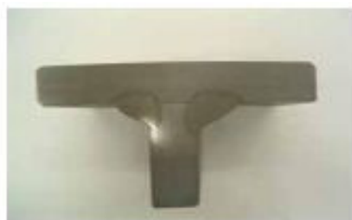
写真-1-1 マクロ試験結果（直ウェブ）
