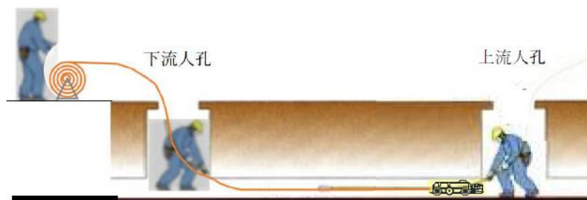
図 2-23 通線によるカメラ調査の様子
