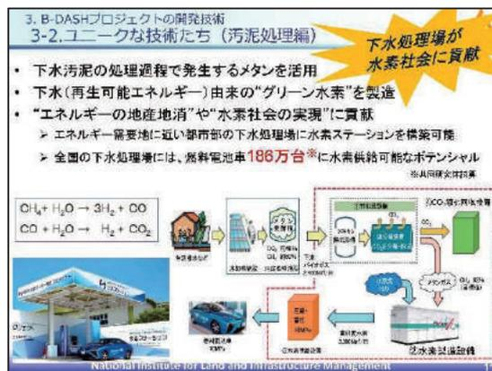
次の技術ですが、こちらは汚泥処理技術になります。下水を処理しますと、その残りかすといいますが、下水汚泥というものが大量に発生いたします。この処理過程でこれを発酵させますと、メタンガスが回収できます。このメタンガスから水素をつくらうという技術です。昨年の報道でも政府では2030年までにこの水素を主力の燃料にしていこうといった報道もございました。この水素を下水処理場で精製して回収できるメタンガスから
