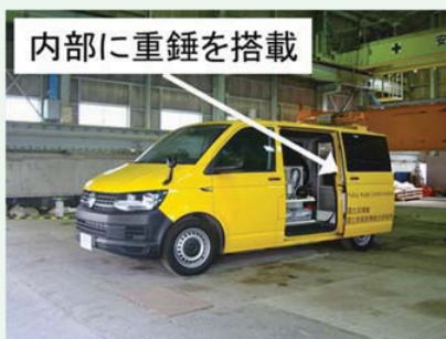
FWD (舗装支持力測定装置)
